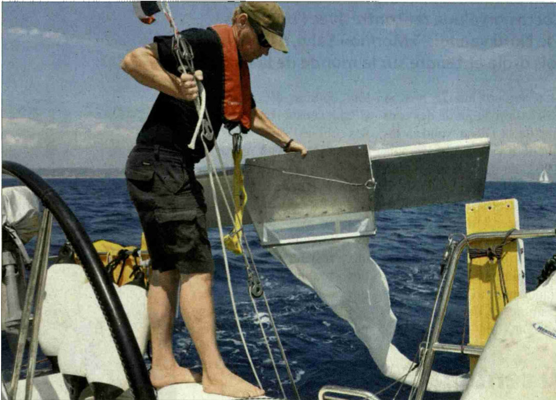
Mise à l'eau d'un système permettant de collecter les échantillons, par filtration.
